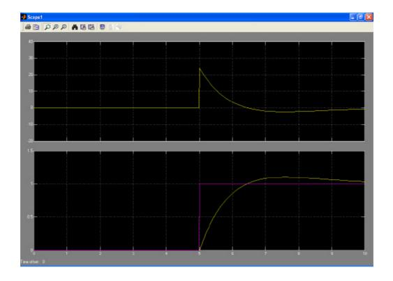
O gráfico acima foi obtido a partir de uma arquitetura Simulink levemente diferente da anterior. O bloco "scope 1" agora possui dois eixos, sendo que no eixo inferior entram duas séries temporais (via bloco "mux"). Para maiores informações sobre esse procedimento consulte o curso de Simulink disponível neste site.
