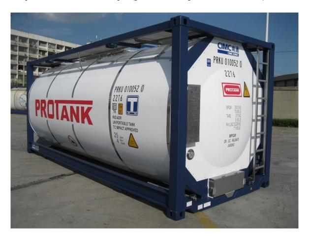
O ISO TANK apresenta 6 metros de comprimento e aproximadamente 2 metros de diâmetro, e transporta 24.000 litros do material.
