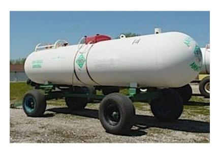
O tanque apresenta 3 metros de diâmetro, 10 metros de comprimento, sendo operado na horizontal. A pressão de armazenamento é de 10 atm — assuma que a amonia está sendo mantida na forma líquida nessa condição. A temperatura de armazenagem é -10°C. Para resistir a essa pressão, a espessura da parede do tanque é de 2 centímetros.
